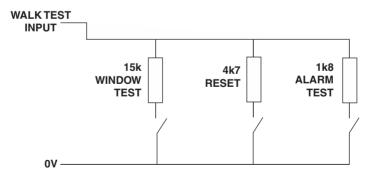
Fig. 9 Walk Test Input
