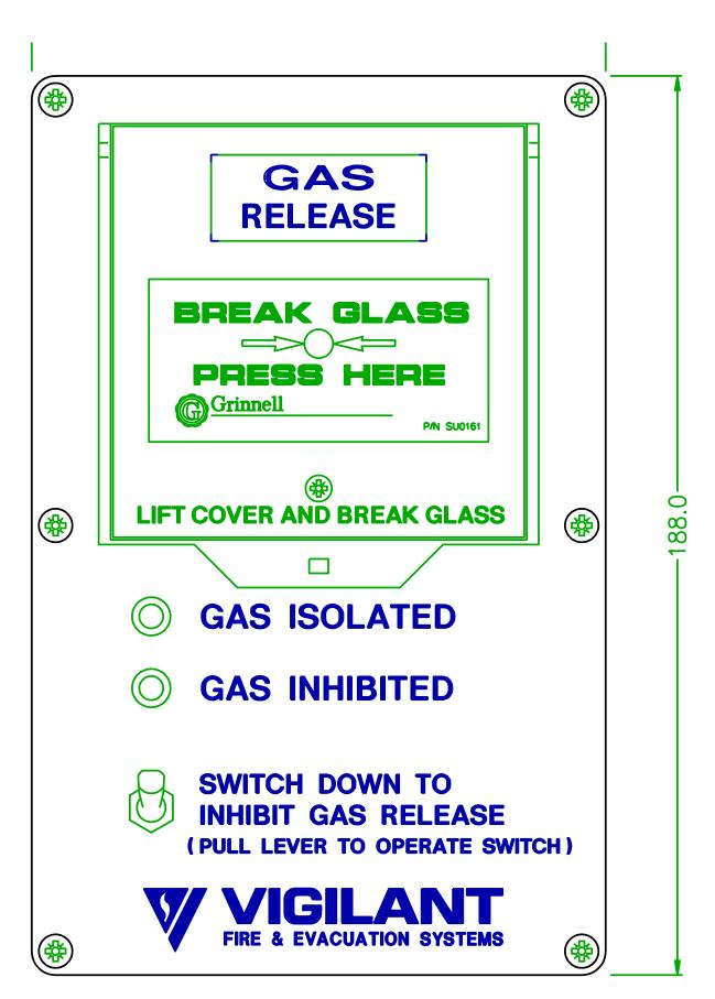
FIG 6.2.6 LOCAL GAS CONTROL STATION, FRONT VIEW
