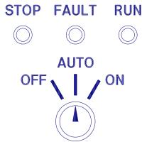
FIG 6.1.1 STANDARD AS1668 MODULE PANEL LAYOUT
