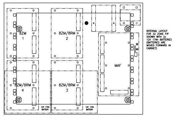
FIG 2.2.2 F3200 SMALL CABINET, MAXIMUM CONFIGURATION
