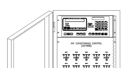
FIG 6.1.2 F3200 WITH TYPICAL AS1668 PANEL (10 UNITS)
