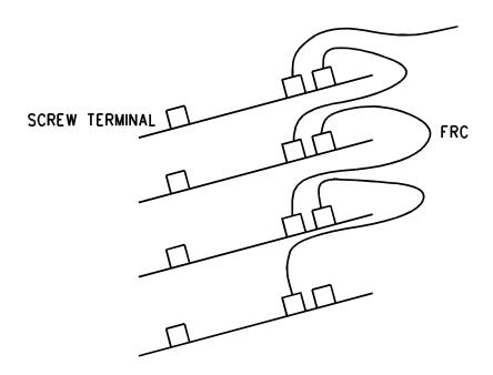
FIG 5.1.2 MODULE CONNECTION WITHIN A CARDFRAME
