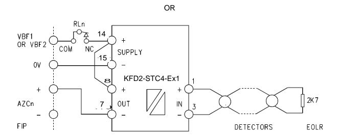
FIG 6.4.3.2 F3200 IS CIRCUIT USING 6-TERMINAL REPEATER
